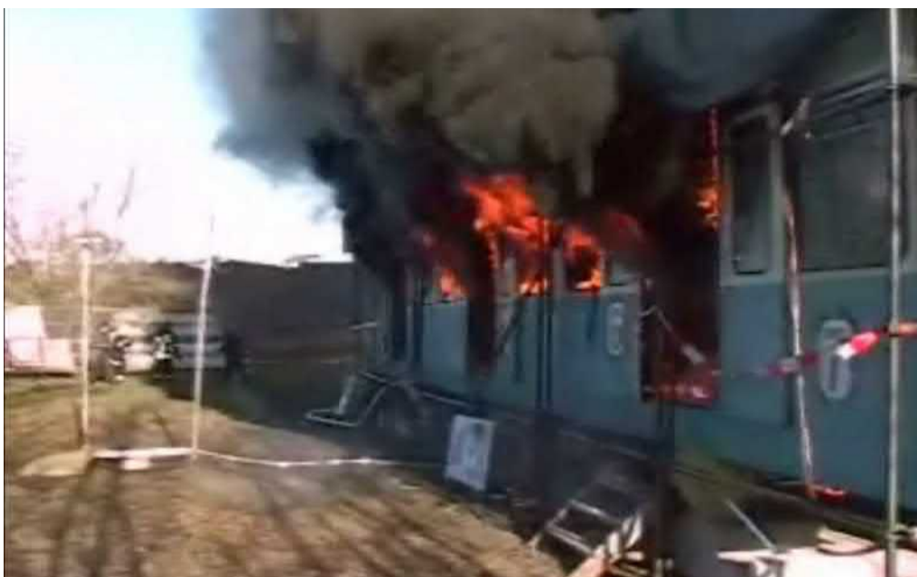
Abbildung 4: Beispiel für Flammen, die aus den Öffnungen eines brennenden Schienenfahrzeugs schlagen
